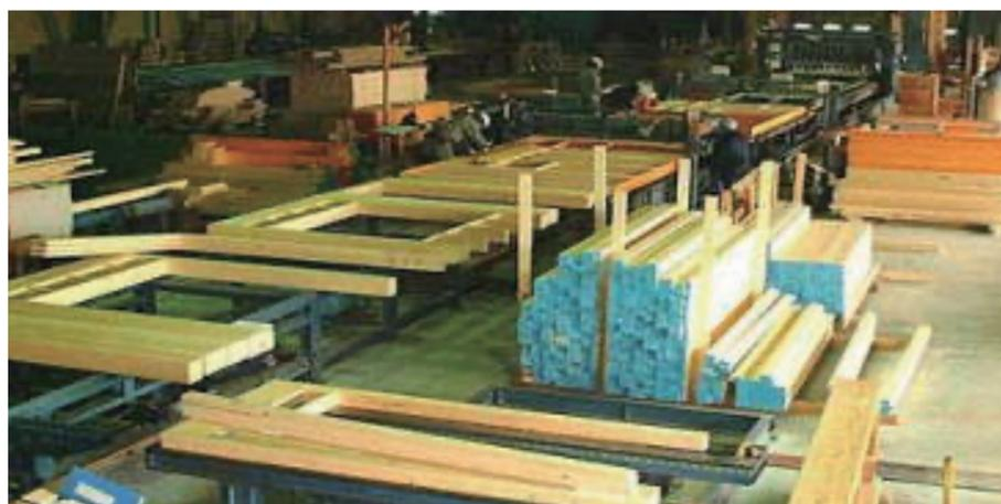
当社、ツーバイフォーパネル・トラス工場は、ディメンションランバーの取り扱いに始まりました。床、壁はパネル、屋根はトラスにすることでより高度な商品作りを目指しています。
